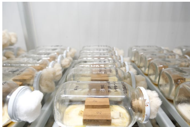
Dispositif d'essai d'évaluation de durabilité naturelle vis-à-vis de champignons lignivores - © FCBA
