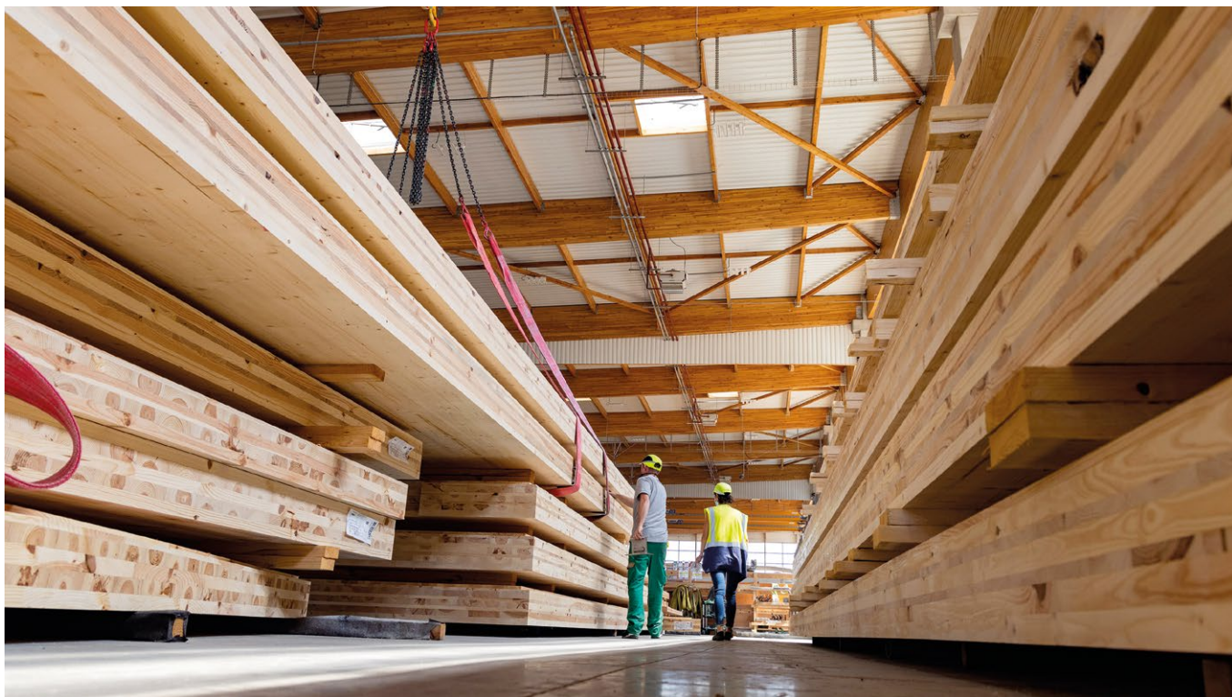
Atelier H40 pour le CLT sur le site de production Les Hauteurs - PIVETEAU à Sainte-Florence (85) | © PIVETEAUBOIS
