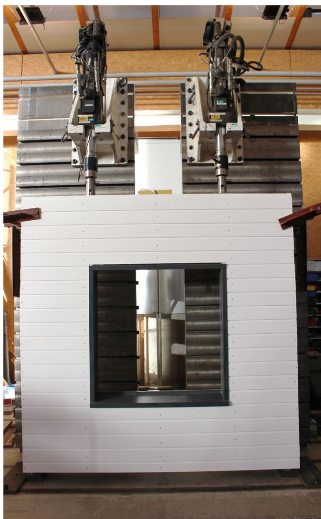
Essais mécaniques sur maquette avec encadrement de baie sur bardage bois
