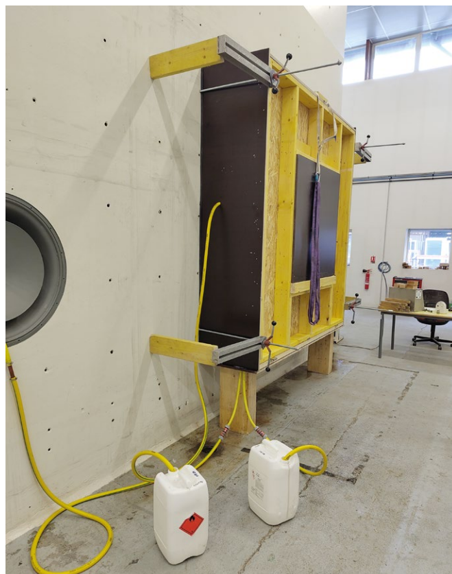
Essai de résistance à la pluie battante sur maquette avec baie : récolte différenciée des eaux en contre-parement et côté pare-pluie
