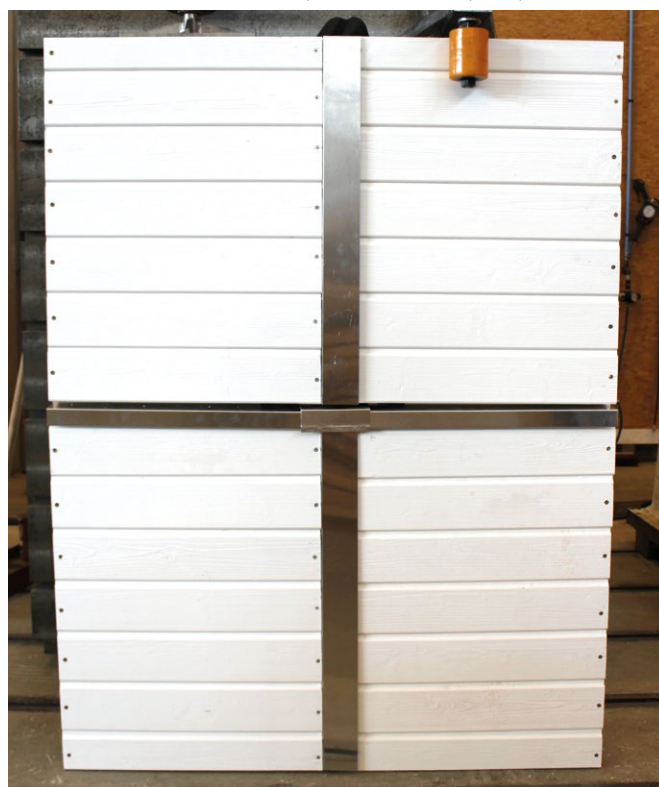
Essais de vieillissement mécanique sur maquette « Croix de jonction »
